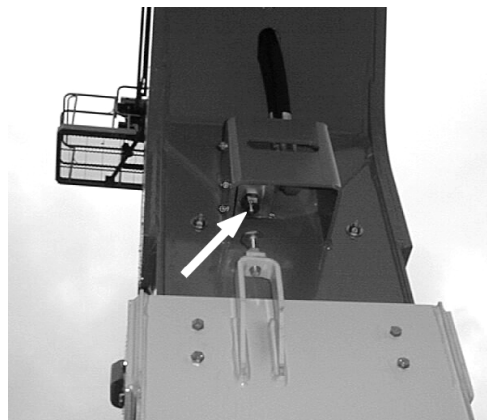
Figura 2-8. Interruptor de fim-de-curso horizontal da lança de torre
